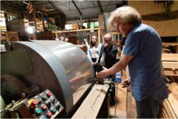
OBM Schiegnitz erklärt die Hobelmaschine für Pfeifenmetall
